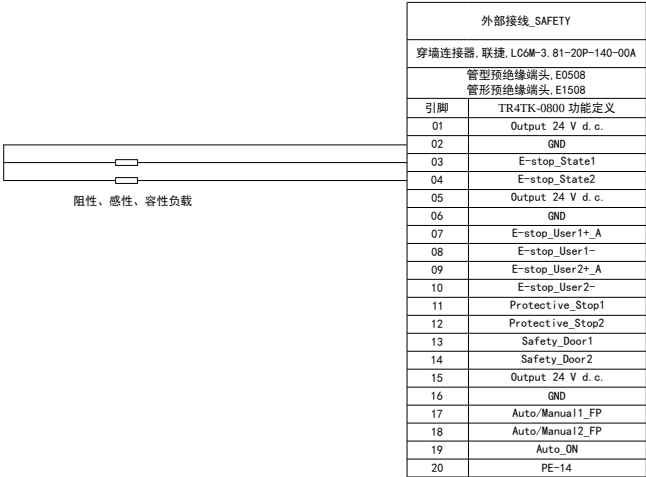
图 2 安全数字输出典型接线图
