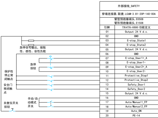
图 4-8 外部 Safety 接线图
