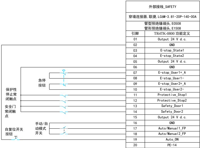
图 1 数字安全输入典型接线图
